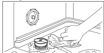
6. Drehen Sie den Deckel des Salzbehälters im Uhrzeigersinn, um den Salzbehälter zu schließen.
