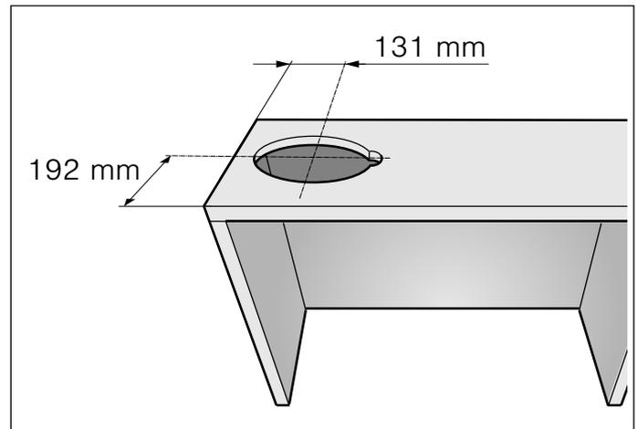
2. Falls vorhanden, Schrankboden entfernen. Befestigungspunkte an den Schrankinnenseiten anreißen und mit einem Stichel vorstechen. Zum Anreißen der Befestigungspunkte die beiliegende Schablone verwenden. **A**
