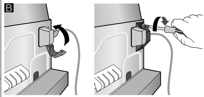
4. 2 Haltewinkel am Gerät anschrauben. Auf die Position der Schrauben achten. **C** Die Schrauben dabei bis auf 8 mm Abstand eindrehen. **D**
