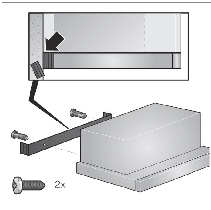
5. Gerät wieder einhängen, ausrichten und festschrauben. Alle Schrauben vorsichtig anziehen.
