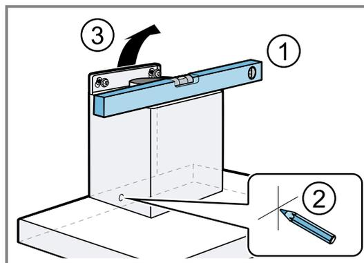
4. Das Loch für die Sicherungsschraube  $\varnothing$  8 mm und Bohrtiefe 80 mm bohren und den Dübel wandbündig eindrücken. ①
