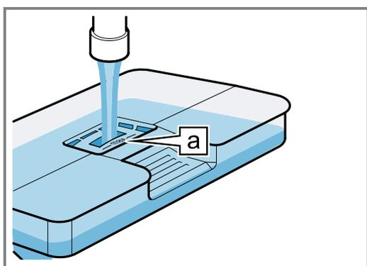
6. Den gefüllten Wassertank einsetzen ①. Dabei darauf achten, dass der Wassertank an den Halterungen [a] einrastet.
