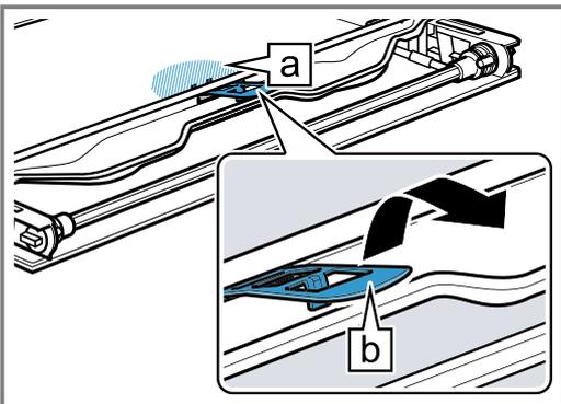
5. Die Zwischenscheibe von unten anheben ① und in Pfeilrichtung herausnehmen ②.
