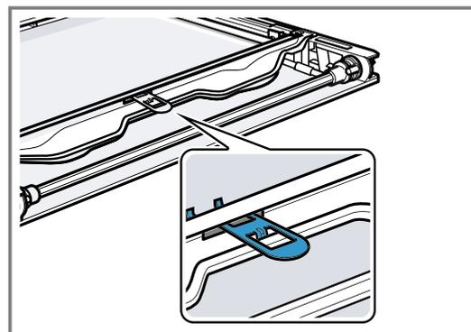
3. Die Innenscheibe schräg nach hinten in die Befestigungsschiene [a] einsetzen ①.
