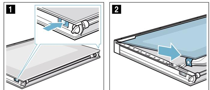
5. Schraubenzieher zwischen Metalllasche **a** und darunter liegenden Kunststoff schieben (Bild **3**).
