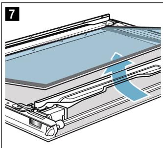
11. Türscheiben und Reflektor von beiden Seiten mit Glasreiniger und einem weichen Tuch reinigen.
