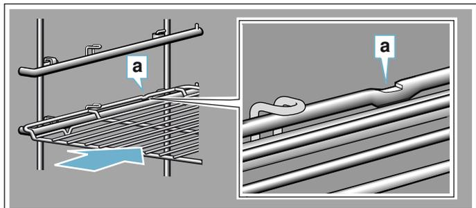
Achten Sie beim Einschieben von Blechen darauf, dass die Rastnase **b** hinten ist und nach unten zeigt. Die Abschrägung des Zubehörs **c** muss vorne zur Gerätetür zeigen.
