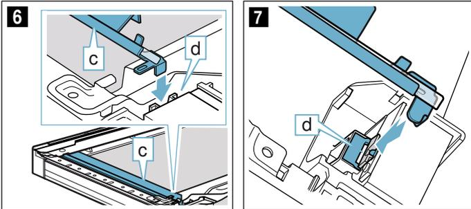
7. Zweiten Reflektor rechts wie den linken Reflektor einsetzen.
