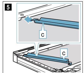
5. Reflektor **c** einsetzen (Bild **6**).
