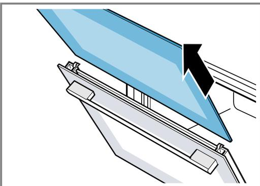
5. Um die Kondensatleiste bei Bedarf herauszunehmen und zu reinigen, die Gerätetür ganz aufklappen.
