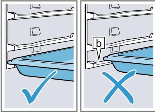
3. Den Dampfbehälter mittig greifen und einschieben.
