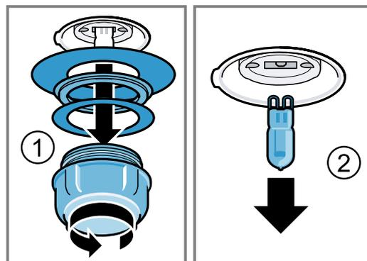
3. Die neue Halogenlampe einsetzen und fest in die Fassung drücken.
