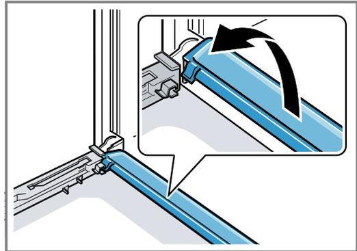
7. Die Türscheiben mit Glasreiniger und einem weichen Tuch reinigen. Die Kondensatleiste mit einem Tuch und heißer Spüllauge reinigen.
