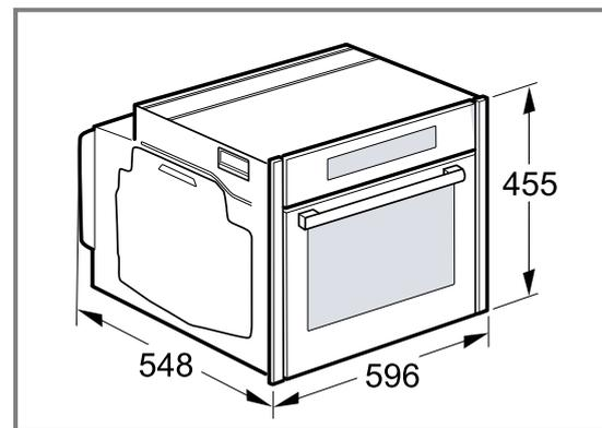
**17.3 Einbau unter einer Arbeitsplatte**
