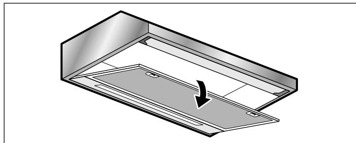
3. Filtergitter schräg positionieren und abnehmen.
