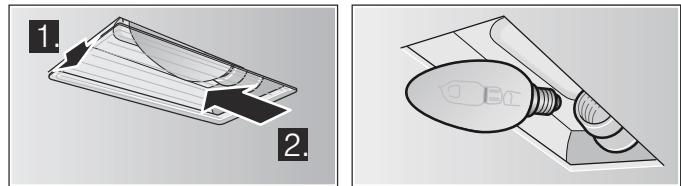
3. Lampafscherming aanbrengen.
