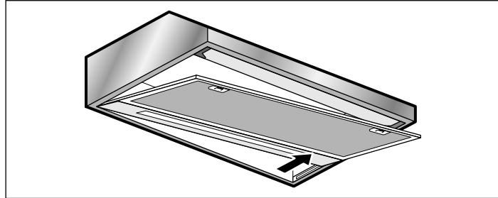
4. Drähte entfernen und Vlies-Fettfilter entnehmen.
