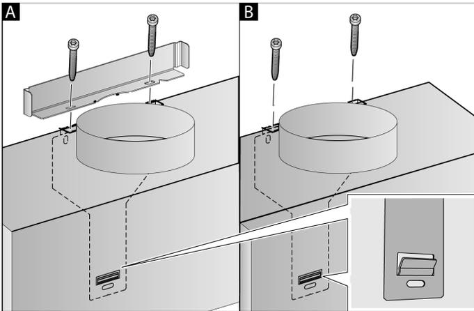
5. Wird kein Kanal montiert, die zwei Sicherungsschrauben ohne Winkel festschrauben. **B**
