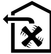
Die angesaugte Luft wird durch die Fettfilter gereinigt und durch ein Rohrsystem ins Freie geleitet.
