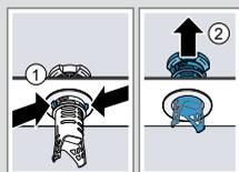
5. Unter fließendem Wasser die Siebelemente reinigen.
