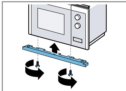
**6. Fijar los cuatro soportes de la base del microondas.**
