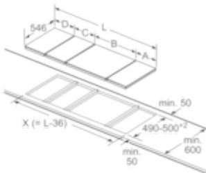
Beim Einbau von mehreren Elementen nebeneinander sind auch mehrere Möglichkeiten für Domino-Kombinationsmöglichkeiten mit entsprechenden Geräte- und Ausschnittmaßen:
